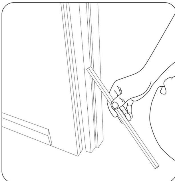
8 Sfilare la guarnizione dal telaio per inserimento viti di fissaggio.
