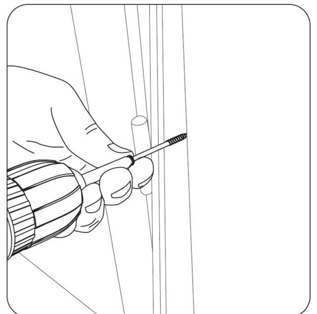
9 Consigliamo il fissaggio della porta al falso telaio inserendo le viti dietro la guarnizione per un montaggio più ordinato.
